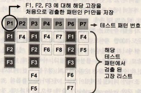
그림 1. 새로운 고장 디셔너리 방식의 기본 아이디어 Fig. 1. Main idea of a new fault dictionary.
